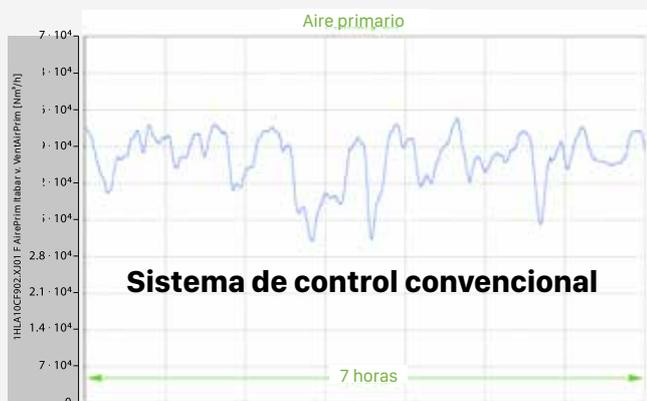
Fig. 28: Caudal de aire primario controlado por un sistema de control convencional
