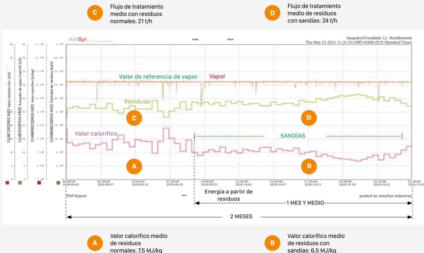
En este caso particular podemos apreciar una incineración de residuos muy eficaz con un alto contenido de agua, lo que debe considerarse un factor estacional debido a la presencia de sandías en los residuos.
