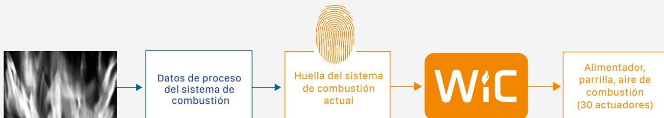
Fig. 13: Los modernos sistemas automatizados proporcionan diversas señales derivadas del proceso de combustión. Esas señales son la huella que determina el estado actual de la combustión.
