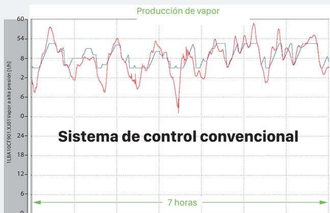
Fig. 26: Produção de vapor controlada por Controlo Normalizado
