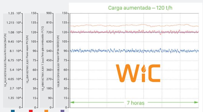
Fig. 4: Conseqüentemente, verificou-se um aumento de carga de 10% em relação ao limite de projeto original (MCR-Potência Máxima Contínua), sem necessidade de alterações mecânicas.
