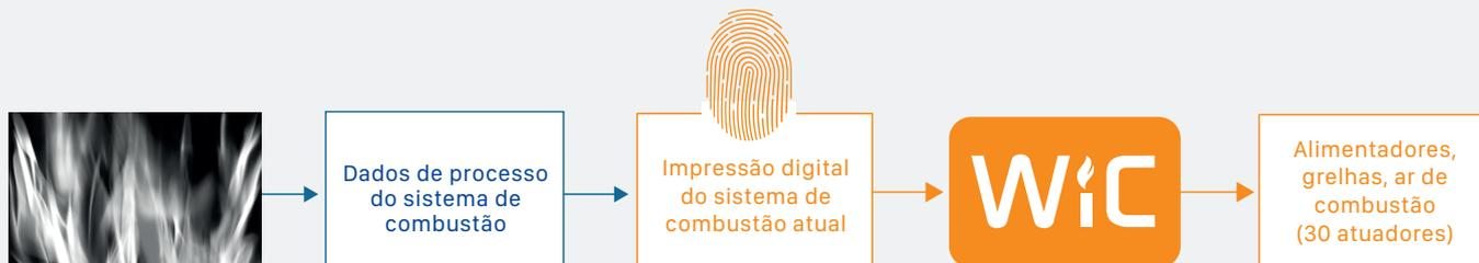
Fig. 13: Os sistemas de automação modernos fornecem vários sinais do processo de combustão. Esses sinais são a impressão digital do estado atual da combustão.
