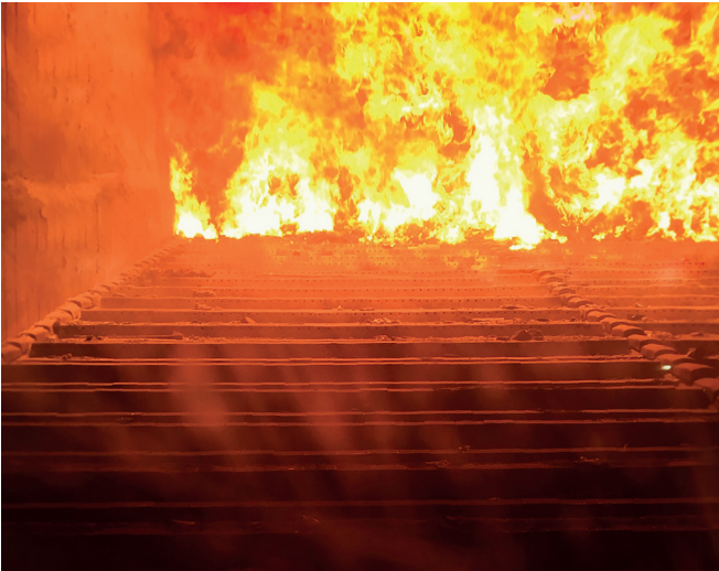
Fig. 7: Princip för gallerförbränningssystemet
